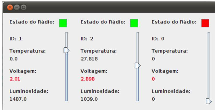
Figura 1: Exibição dos resultados do monitoramento de nodos sensores.
